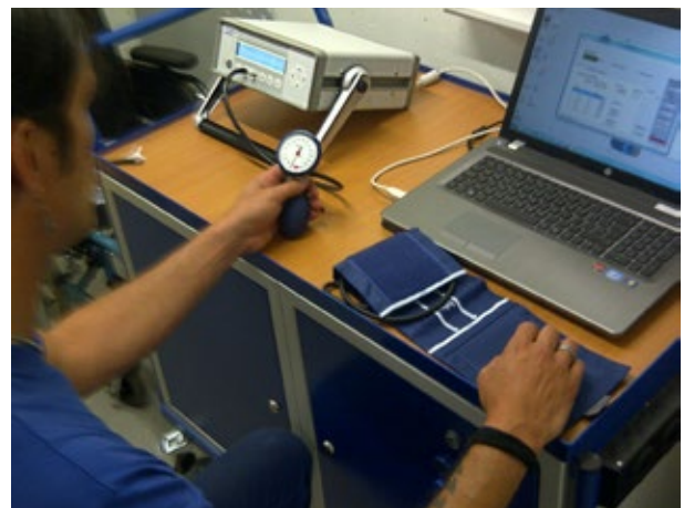
Aus der Praxis: So werden die Blutdruckmessgeräte im Pflegeheim Solina in Spiez (Schweiz) vom verantwortlichen Techniker kalibriert
