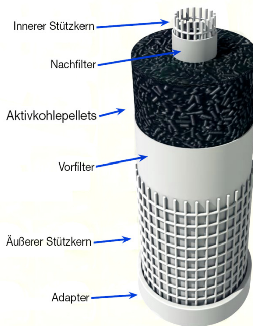
Aufbau der Aktivkohle-Pellet-Kerze
