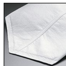
Verschweisste Beutel haben keine Bypässe durch Nadellöcher.
